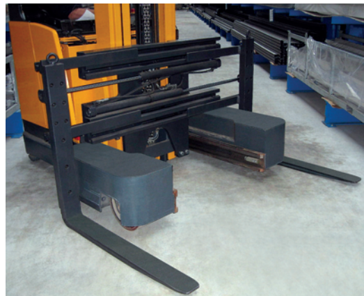
ZVKGs-H, hochgezogene Ausführung für Schubmaststapler
